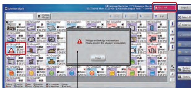
Wyskakujące okienko z informacją o wycieku
